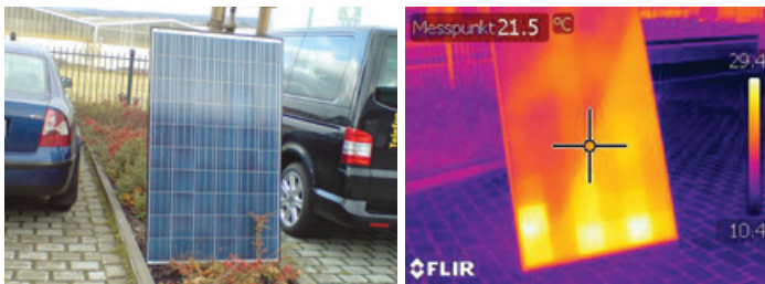
Un test con un pannello solare mostra che i punti caldi possono essere individuati molto facilmente nell'immagine termica, anche dalla parte anteriore.
