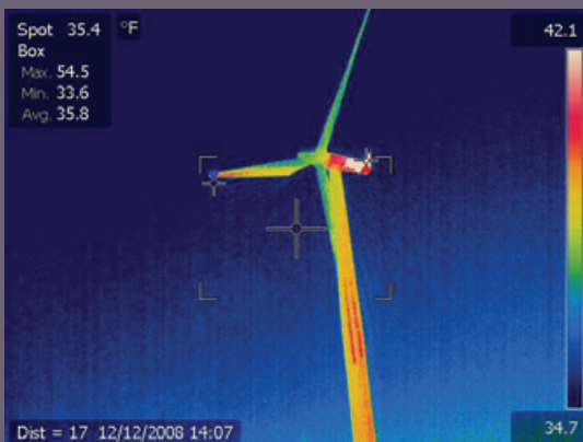
Immagine termica di una turbina eolica ripresa dal suolo
