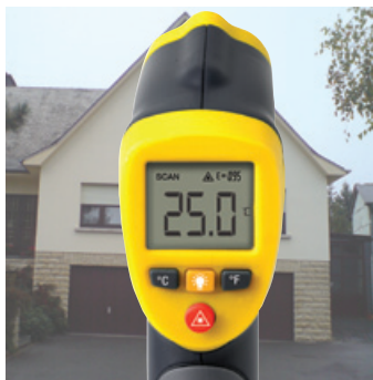
Termometro IR, misurazione della temperatura in un singolo punto
