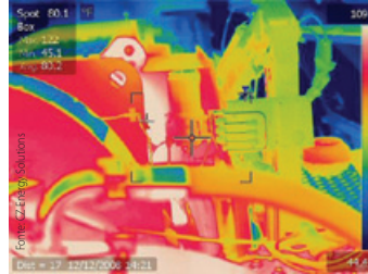
Ispezione termografica della trasmissione di una turbina eolica. Ispezione termografica svolta a circa 50 metri di altezza.
