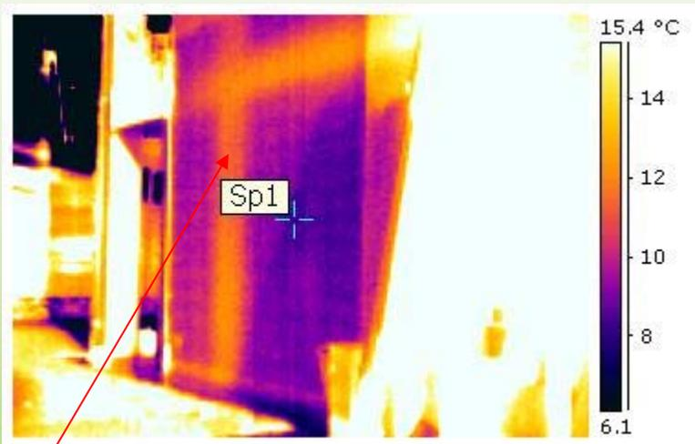
ponte termico pilastro e codolo
